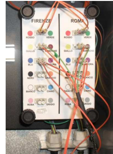
Elettronica del colonnino per Diffusione Sonora e Telefonia d'Emergenza
