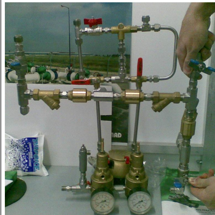
Sistema di pilotaggio della Idrovalvola completo di kit controllo rottura tubazione
